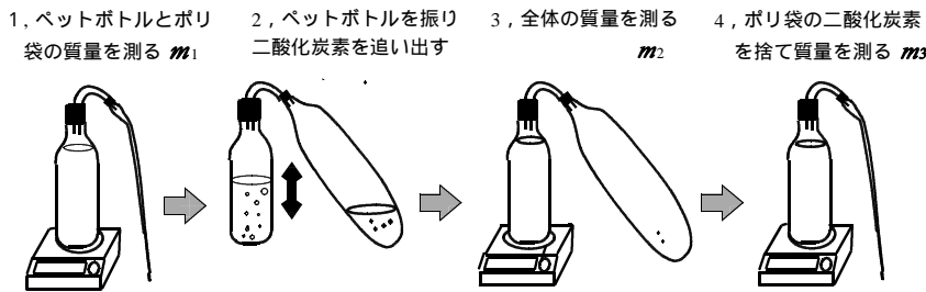
図5 ペットボトル入り炭酸飲料の分子量測定
